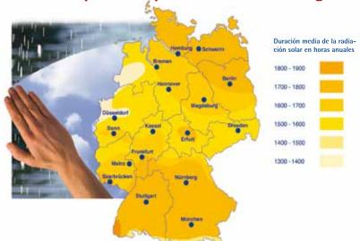
La radiación solar anual de Alemania alcanza cotas suficientes para aplicar el uso de la energía solar. En nuestra latitud una instalación paralela a la red de un 1 kWp puede producir una energía anual de entre 800 y 1.000 kWh\* por año. En otros países o continentes, rendimientos anuales de hasta 1.800 kWh son posibles.
